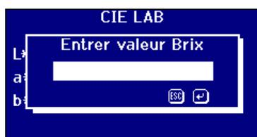
Si l'échelle colorimétrique ICUMSA a été sélectionnée et la valeur Brix a été fixée sur un réglage manuel, l'écran suivant apparaît.
