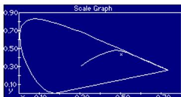
Le graphique indique la ligne de l'échelle colorimétrique sur le diagramme de chromaticité xy CIE. L'échantillon mesuré est indiqué sous forme de "x".
