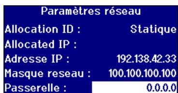
Appuyez sur **▲** ou **▼** pour placer la barre de mise en évidence sur "**Masque de sous-réseau**".
