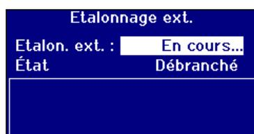
L'instrument prend alors contact avec le serveur de calibrage de The Tintometer Ltd. Une fois qu'une connexion a été établie, l'**"Etat"** indique "Connecté".
