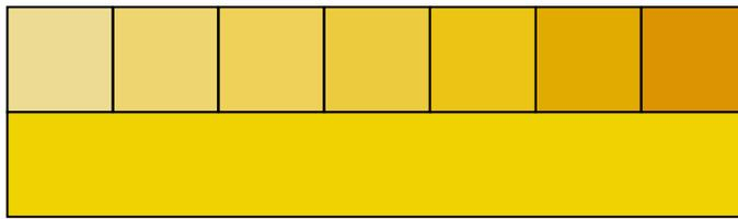
Dans l'exemple suivant, la couleur la plus proche correspond toujours à l'étalon indiqué par la flèche, mais le facteur hors-teinte est passé à 11. Dans cet exemple, on s'attendrait à ce que le résultat d'une comparaison visuelle indique le 6<sup>ème</sup> étalon.
