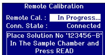
Toutes les solutions du kit de calibrage seront demandées à tour de rôle et l'opération de mesure devra être effectuée pour chacune des solutions. La solution utilisée devra être jetée après l'emploi et ne devra pas être remise dans la bouteille.
