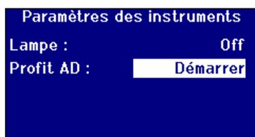
Une fois la lampe changée, il faut effectuer les réglages du gain de l'instrument. Placez la barre de mise en évidence sur **"Réglage du gain analogue/numérique"** et appuyez sur ↵ pour démarrer le processus.
