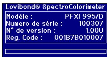
A l'allumage de l'instrument, l'écran affiche le numéro de modèle, le numéro de série et la version de micrologiciel installée.
