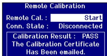
Une fois les mesures vérifiées, le serveur de calibrage renvoie un message de confirmation à l'instrument. Un e-mail contenant le certificat de calibrage sera envoyé à l'adresse électronique préalablement enregistrée sur le site de calibrage.
