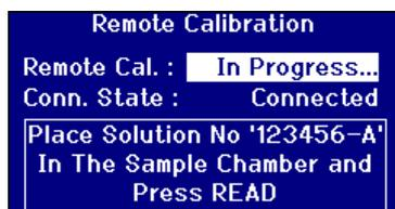
Une fois la mesure de ligne de base terminée, l'écran affiche une solution pour la mesure. Le numéro de solution dépend du code du kit.
