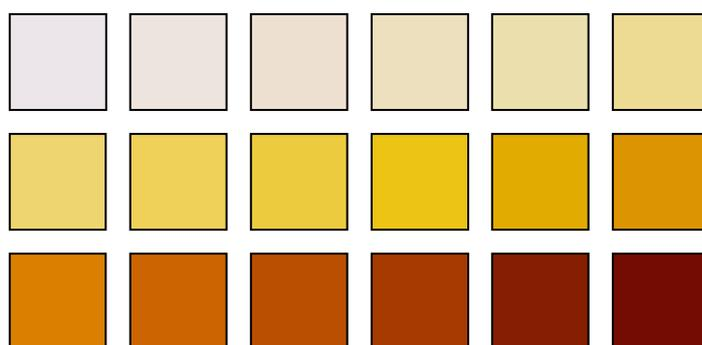
Si l'échantillon mesuré a une teinte similaire à celle de l'une des étalons colorimétriques, il est facile pour l'utilisateur d'établir une correspondance dans le système visuel. On peut le constater sur le diagramme ci-dessous, sur lequel les différents étalons colorimétriques apparaissent sur le haut et l'échantillon à mesurer en dessous. Il est évident que l'étalon indiqué d'une flèche est la meilleure correspondance.
